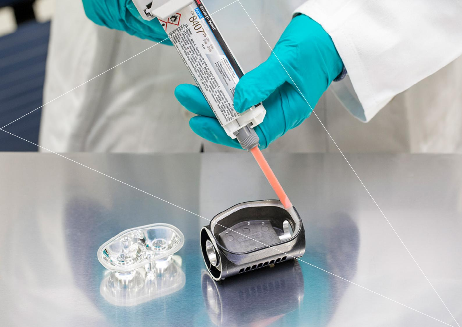
der Pulverlackierung widersteht. DP 8407 NS hat sich zu einer gefragten Alternative für Epoxidharz-Klebstoffe entwickelt – er hält nicht nur in Sachen Festigkeit und Temperaturbeständigkeit mit. DP 8407 NS ist vor allem in weniger als 24 Stunden endfest. Verglichen mit den sieben Tagen für Epoxidharz-Klebstoffe ist das Schallgeschwindigkeit!
